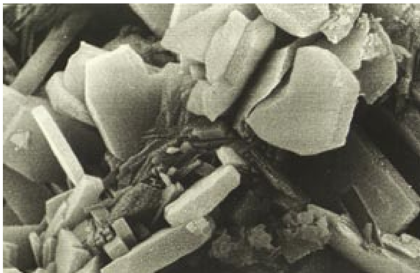
● Рис. 2. Электронная микрофотография кристаллов клиноптилолита (крупные пластины) в смеси с тонкими вкраплениями сопутствующих минералов
